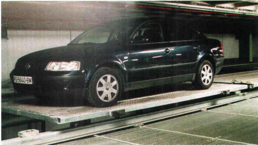
La plataforma rodante, de estructura metálica, está soportada sobre un tren de ocho ruedas.
